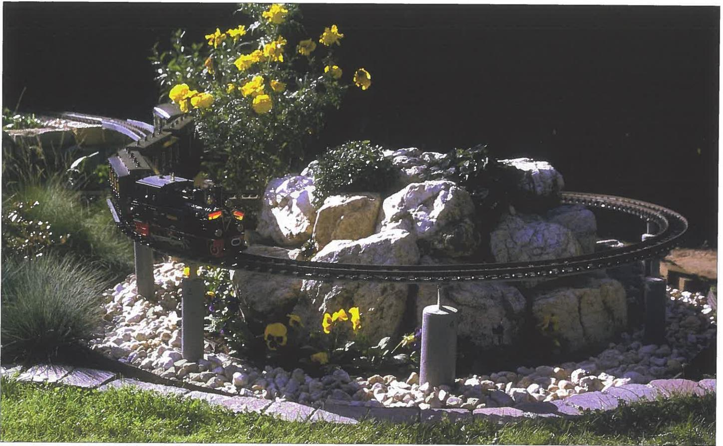
Überwindung des Höhenunterschiedes mit einer Gleisroststrecke.
