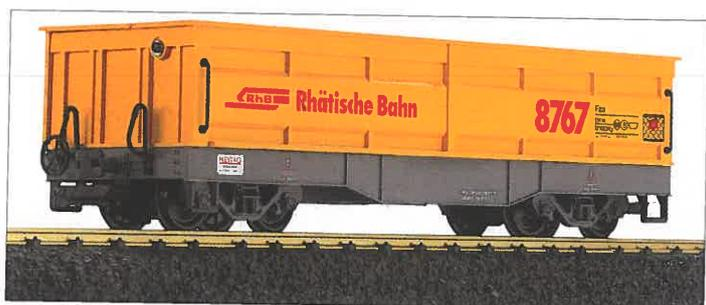
LGB 41614: Zur Abfuhr des Ausbruchs beim Bau des Vereina-Tunnels setzte die Rhätische Bahn vierachsige Spezialwagen ein. Dieser LGB-Wagen hat einen schräg ausgeführten Wagenkastenboden. Eine Seitenwand läßt sich von Hand anheben, so daß das Ladegut herausrutschen kann. RhB-konforme Lackierung und Beschriftung.
