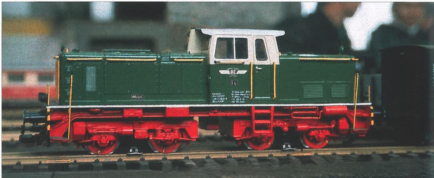
**Günter Voeller:** Die Brohltaldiesellok D4 entstand aus einer LGB 2151 (DB V 251), die nach einigen Umbauten am Gehäuse nun dem Original sehr ähnelt.
